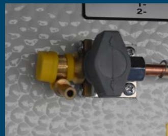
Ein Gasanschluss im Staufach ermöglicht es Ihnen, auf das Mitführen von Gasflaschen für den Grill zu verzichten – schließen Sie Ihren Grill einfach an den eigenen Gasvorrat des Wohnwagens an.
